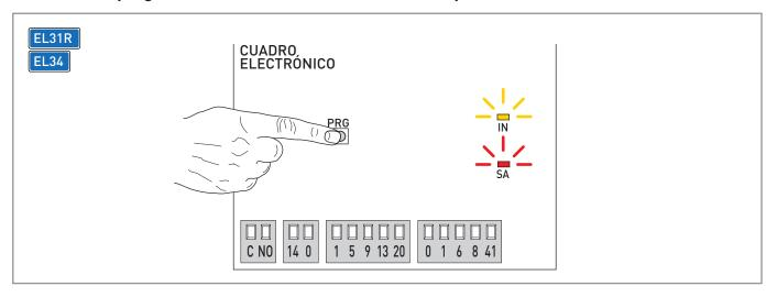
En los cuadros electrónicos para cancelas o puertas seccionales no dotados de pantalla, para iniciar correctamente la programación, siga el procedimiento:
