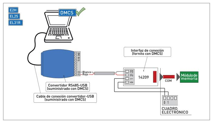
En los cuadros electrónicos que no están dotados de terminal de bornes serie, es posible conectar el convertidor RS485-USB al cuadro electrónico utilizando la tarjeta de interfaz de conexión 14209 como se indica en la figura.
