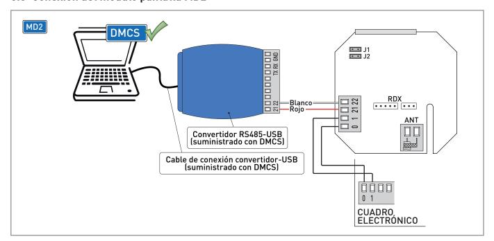
Es posible conectar el convertidor RS485-USB al módulo pantalla MD2 como se indica en la figura.
