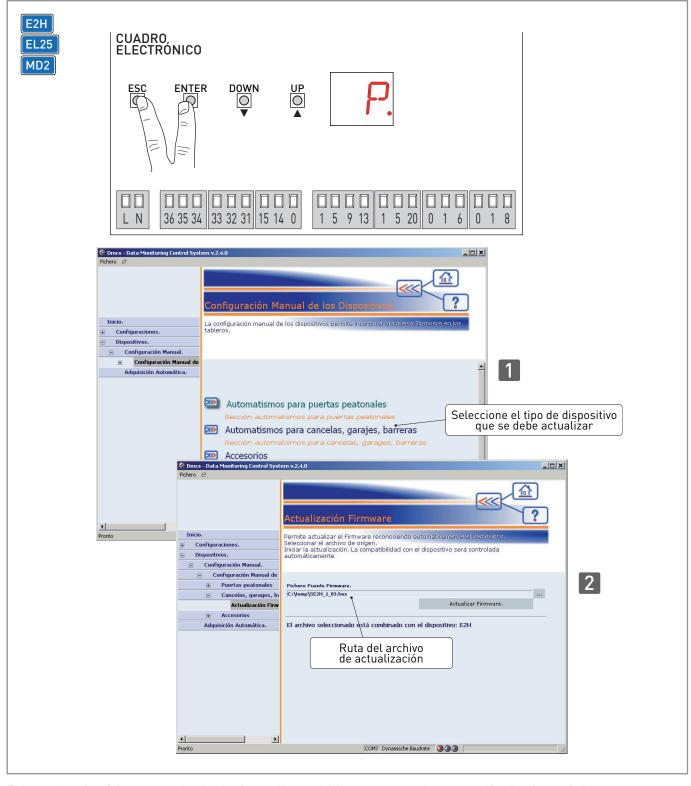
En los cuadros electrónicos y accesorios dotados de pantalla, para iniciar correctamente la programación, siga el procedimiento:
