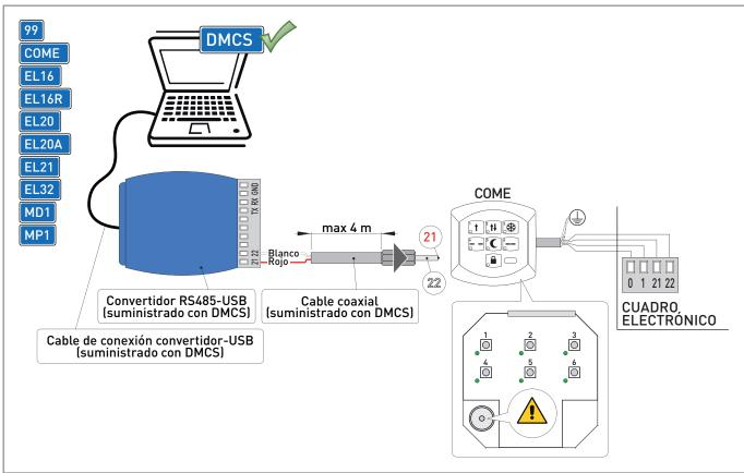
En los cuadros electrónicos dotados de terminal de bornes serie, es posible conectar directamente el convertidor RS485-USB en el cuadro electrónico utilizando los cables coaxiales suministrados como se indica en la figura, o el cable blindado para la transmisión de datos (no suministrado). Es posible conectar el convertidor RS485-USB al cuadro electrónico también utilizando el conector correspondiente presente en el selector de funciones COME (si está presente).
