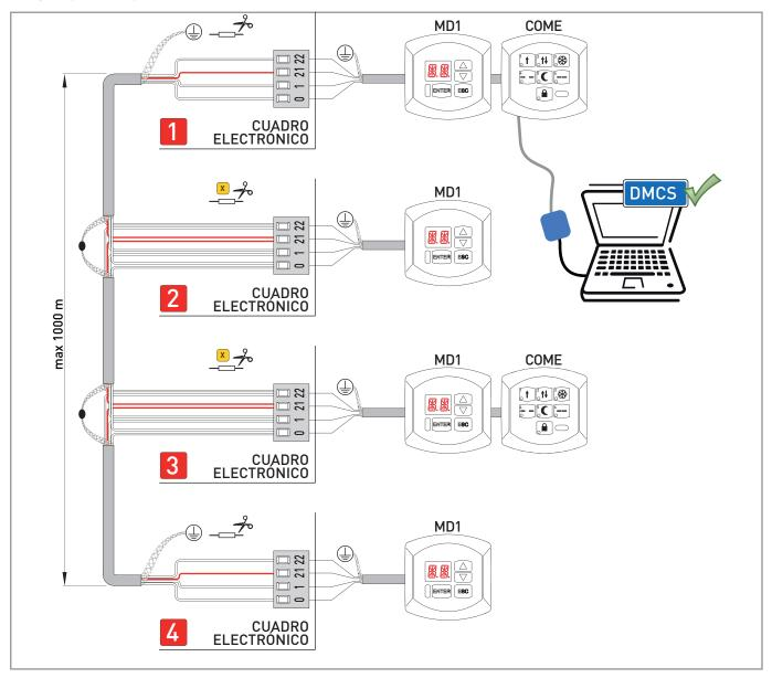
En el caso de automatismos conectados en red para puertas automáticas con selector de funciones, efectúe las conexiones eléctricas indicadas en la figura. En la configuración de la figura, es posible gestionar hasta cuatro automatismos con uno o dos selectores de funciones COME. Cuando el dispositivo DMCS gestiona cuatro automatismos, corte la resistencia indicada [X] en los cuadros electrónicos [2] y [3].
