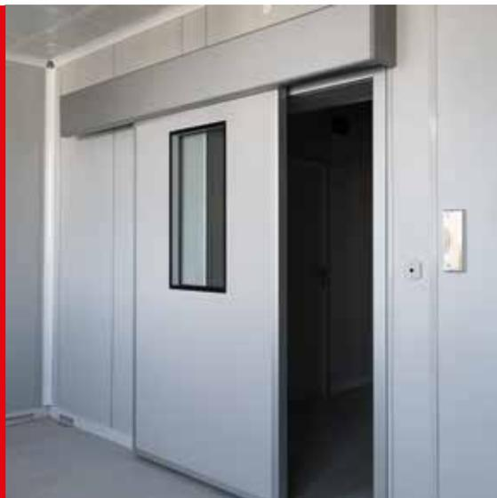
Ditec VALOR HS est l'automatisme coulissant à même de garantir des fermetures semi-étanches ainsi qu'un silence et une hygiène maximaux pour tous les milieux hospitaliers. De plus, VALOR HS atteint une force maximale de 500 kg sur deux vantaux ou de 450 kg sur un seul vantail (idéal pour le service de radiologie étant donnée la nécessité de vantaux blindés au plomb).
