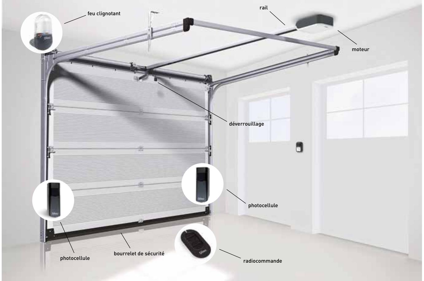
L'automatisme peut être complété avec des dispositifs de commande, de contrôle et de sécurité Ditec.
