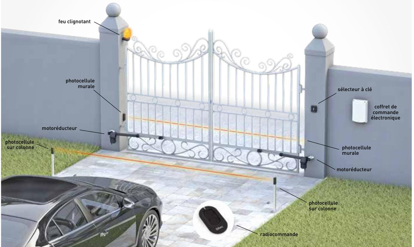
L'automatisme peut être complété avec des dispositifs de commande, de contrôle et de sécurité Ditec.
