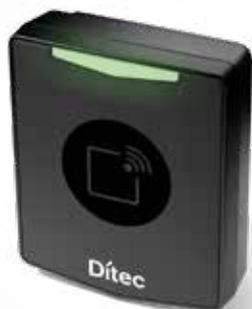
**Ditec AXR7** è un sistema di comando che utilizza la tecnologia RFID a transponder permettendo la lettura e il riconoscimento di un bottone o tessera codificati tramite un semplice accostamento o sfioramento.
