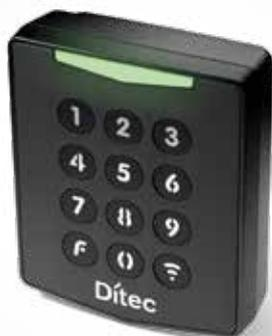
**AXK4** (433,92 MHz) e **AXK4P** (868,35 MHz) são teclados de rádio digital para o controle de automação através de 4 códigos numéricos personalizáveis. Duas opções de fonte de alimentação: com bateria de 9 Vcc ou via conexão de painel elétrico de 24 Vcc. Configurável através do teclado do botão de pressão ou do ZEN Pad e do ZEN MANAGER. Teclado retroiluminado e luz integrada para sinais de status.
